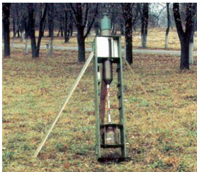
Рис. 2.34. Кумулятивно-фугасный заряд КФЗ-1
