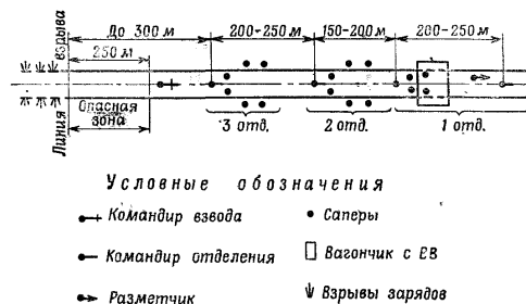
Рис. 200. Схема организации подрывания верхнего строения пути поточным методом
